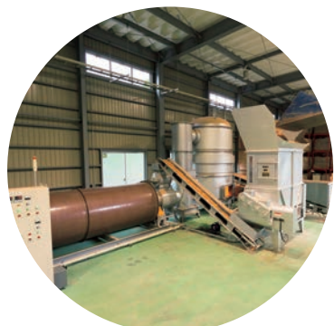
破碎したチップを 乾燥機で乾かす。
