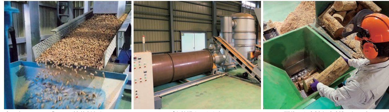
木に含まれるリグニンが接着剤となり、木粉が直径0.6センチ、長さ2センチのペレットになる。 チップを乾燥させたあと、粉状にしてペレット成型機へ。 間伐した木材を破砕機で細かくチップ状にする。
